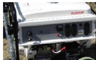
プロパンガス使用発電機
